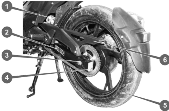
Рис. 6.7. Ланцюгова передача і маятникова підвіска
