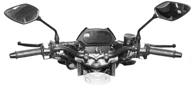
Рисунок 3.2. Загальний вид керма
