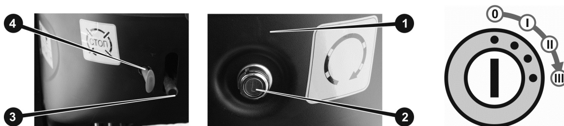
Рисунок 3.8. Центральний вимикач («замок запалювання»)
