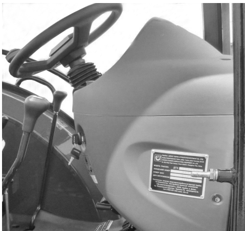
Рисунок 1.1. Розміщення номера шасі
