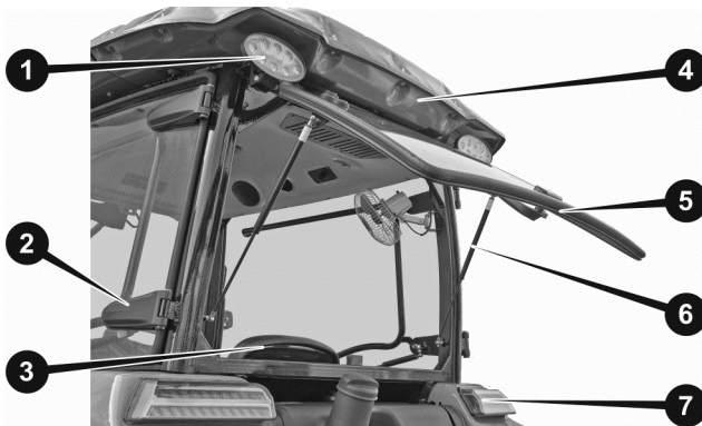
Рисунок 3.11. Фіксатори заднього скла
