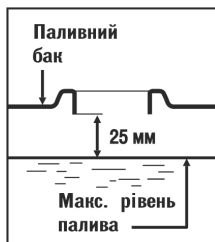
Рисунок 14 – Горловина паливного баку
