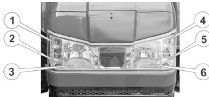
Малюнок 3.6 – Передні прилади освітлення
