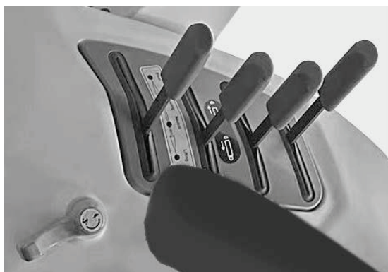
Рисунок 6.6. Управління навісним механізмом
