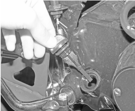
Рис. 6.1. Перевірка рівня мастила у двигуні
