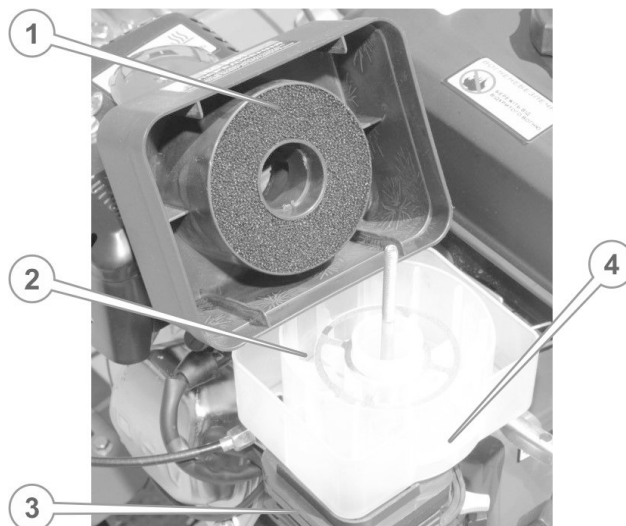
Рисунок 6.1. Поролоновий повітряний фільтр з масляною ванною
