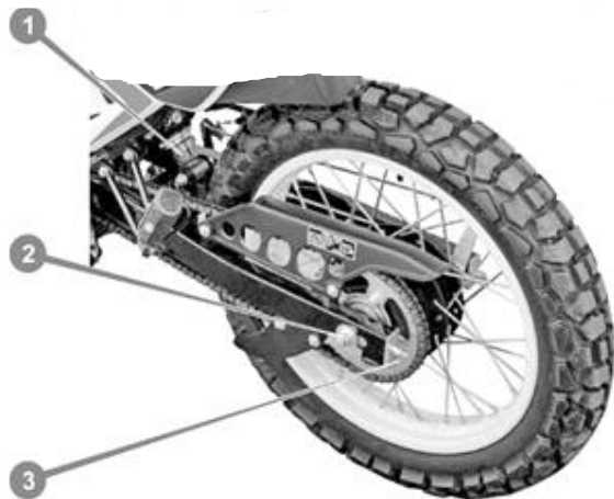
Рисунок 16. Ланцюгова передача і маятникова підвіска
