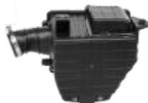
Рисунок 6.5. Повітряний фільтр і фільтрувальний елемент
