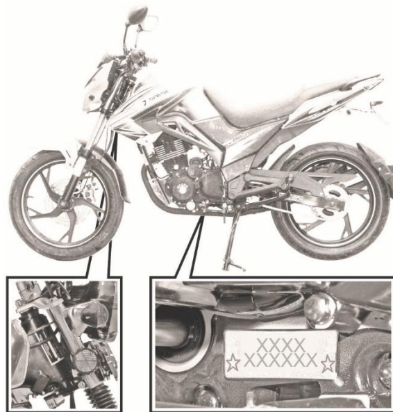
Рисунок 3.7. Розташування номера двигуна мотоцикла
