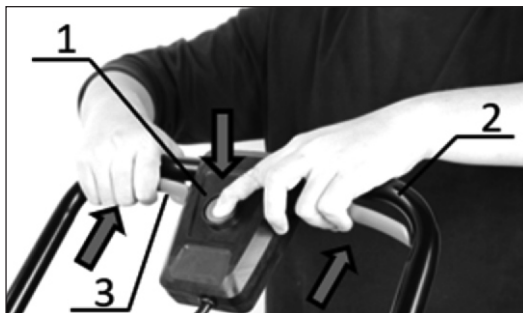
1. Кнопка перемикача; 2. Верхня ручка; 3. Важіль перемикача
