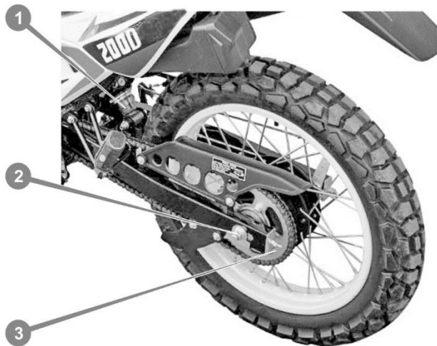
Рисунок 16. Ланцюгова передача і маятникова підвіска
