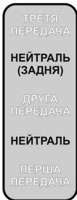
Рисунок 4.11. Послідовність перемикання передач
